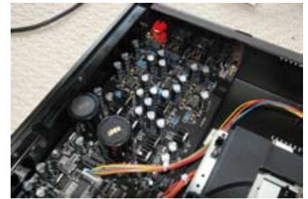
De uitgangstrap van de CDP4A gebruikt opamps maar wel de beste in zijn soort.
