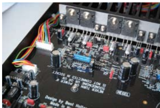
Het speciale (blauwe) SoundEngine correctienetwerk is prominent aanwezig in het midden van ieder versterkerkanaal.
