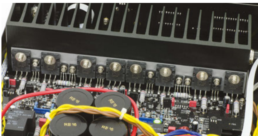
Ogni canale monta due coppie di bipolari Toshiba ZS2121/2sc5949 (15 ampere, 220 watt). La loro Ft tipica è di 25 megahertz.
