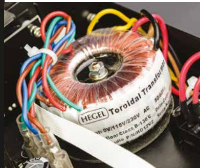
Zasilacz ma trzy stabilizowane gałęzie napięć produkowanych przez umiarkowanej wielkości, choć i tak nadmiarowy toroid.
