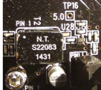
Nell'HD30 sono presenti diversi esemplari di questo minitrasformatore al fine di isolare galvanicamente il convertitore dalle sorgenti digitali a cui viene connesso.
