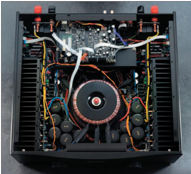
一半，實物所見 H590 除每聲道使用 12 片日本製造的強力晶體管外，機身中央主要負責後級供電的巨型環牛容量亦特別高，配上左右每邊六支 Nover 巨型濾波電容和大型散熱器，放大級的處理和製作毫無疑問翻版自 H30 分體旗艦而來，且固態放大電路板的銅跡厚  $70 \mu\text{m}$  或以上，而模擬音頻通道上亦大量使用誤差特低的 WIMA 聚丙烯電容和各類音響級零件。為免功能不同的多元化電路在內部互相干擾，前級和數碼電路使用位處後方的另一隻獨立環牛負責供電，並以金屬板把上方的 uPnP/DLNA 多媒體串流和解碼電路隔開，為保証靚聲做好一切可行準備，亦使這部全功能機種在  $2\Omega$  負載時依然保持穩定，是 H590 絕對不容小覷的地方！
