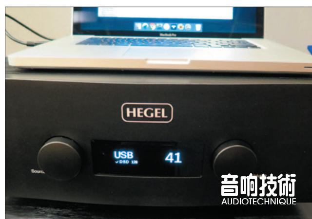
就連 MQA 的 24bit/352.8kHz 音檔都難不到 Hegel H590，各類 DSD 和 PCM 音檔自然易如反掌！
