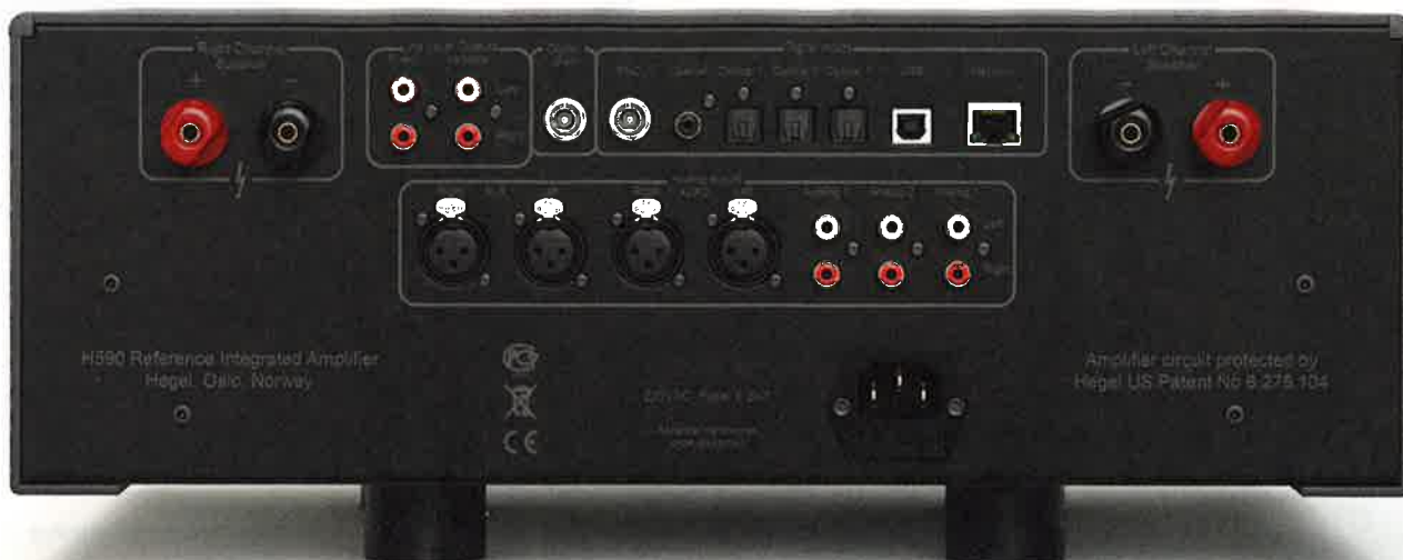
Der Hegel H590 ist ein wahrer Brocken. Fünf analoge Eingänge, darunter 2 x XLR, plus sechs digitale Eingänge inklusive USB-B plus Netzwerkanschluss sorgen für Quellenvielfalt. Sympathisch: stabile Lautsprecherklemmen in einfacher Ausführung.
