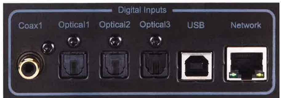
▲ Die Konzentration auf optische Eingänge zeigt, dass der Röst vor allem als Spielpartner für Geräte wie einen Sonos Connect, Apples TV oder einen Flachbildfernseher ausgelegt wurde.
